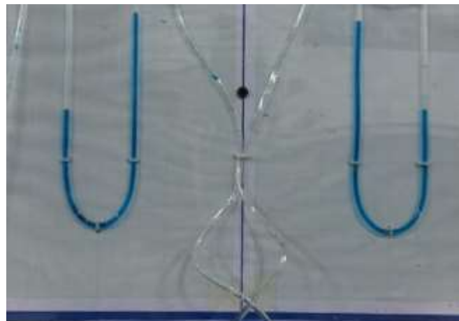
Gambar 11. Uji manometer U pada milimeterblok
