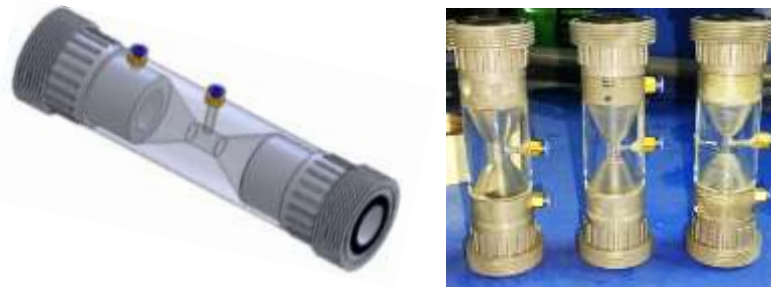
Gambar 1. Desain Tabung Akrilik dan hasil pembuatan
