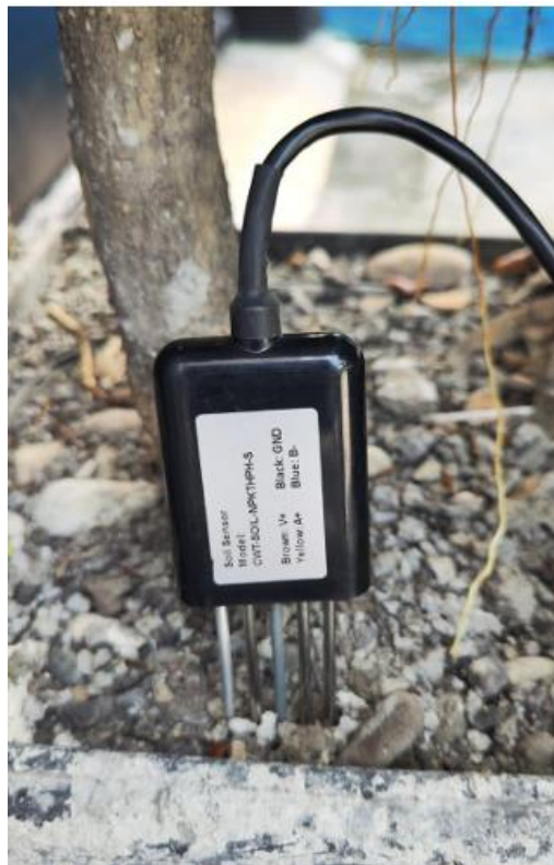
Gambar 5. Bentuk Probe saat ditancapkan di dalam tanah
