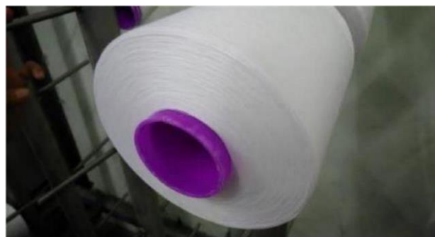
Gambar 2.3 Cacat Benang Tanpa Ekor
