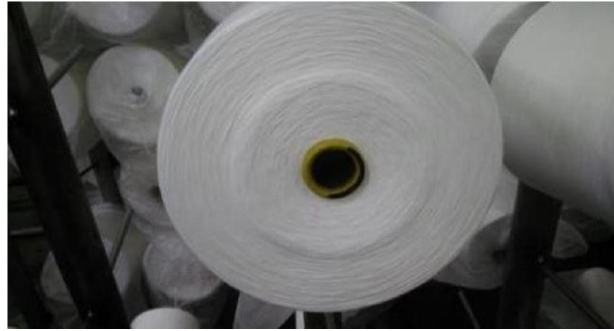
Gambar 2.2 Cacat Benang Swalot
