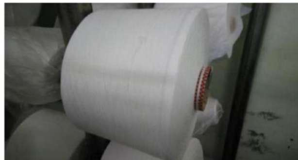
Gambar 2.4 Cacat Benang Belang
