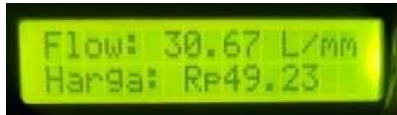
Gambar 7. Pengujian Debit Air pada LCD I2C 16x2
