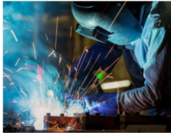
Gambar 8. Proses Pengelasan SMAW
