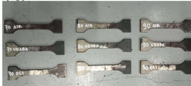
Gambar 11. Spesimen Pengujian Tarik
