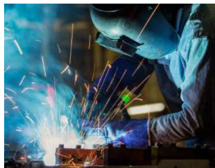
Gambar 8. Proses Pengelasan SMAW
