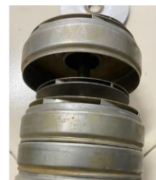
Gambar 5 Spesifikasi Struktur Impeller Pompa Jockey Tipe CR Vertical Multistage Centrifugal
