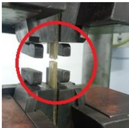
Gambar 10. Proses pengujian tarik komposit
