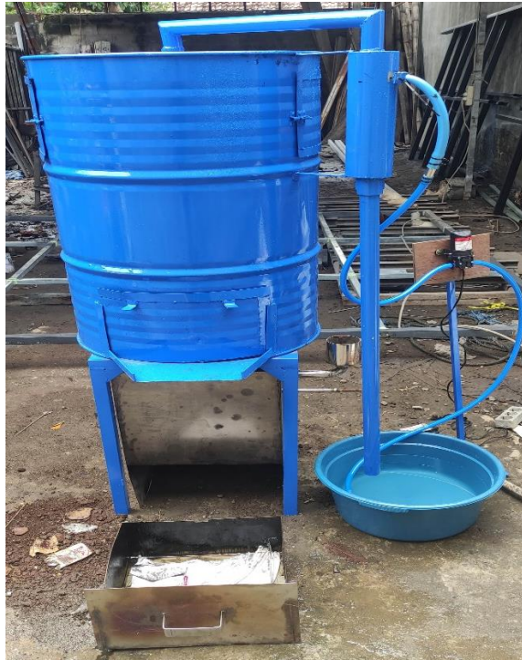
Gambar 6. Hasil assembly proses manufaktur kompor pelebur sampah
