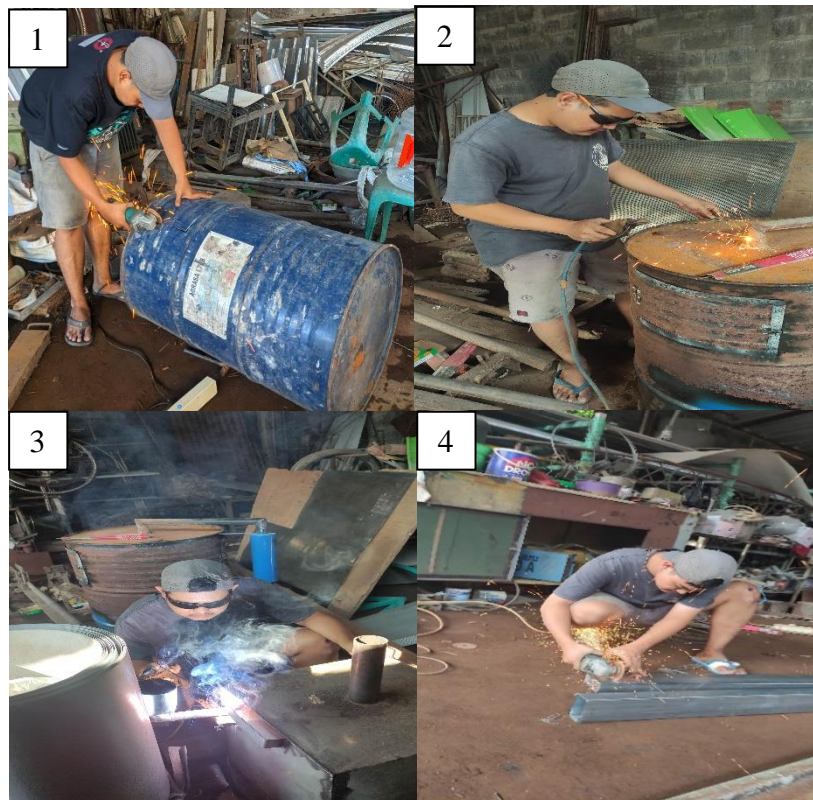
Gambar 4. Proses manufaktur kompor pelebur sampah
