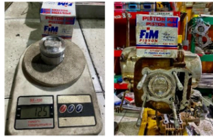
2. Gambar kedua (Piston Casting) • Berat : 125 gram
