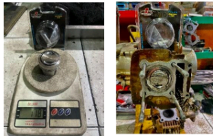
3. Gambar ketiga (Piston Forged) • Berat : 118 gram
