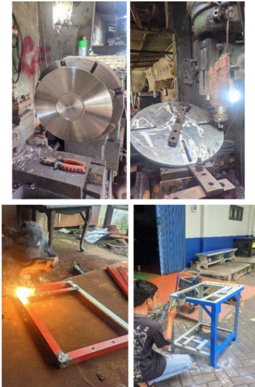
Gambar 4. Proses Manufaktur mesin perajang pisang kapasitas 59kg/jam
