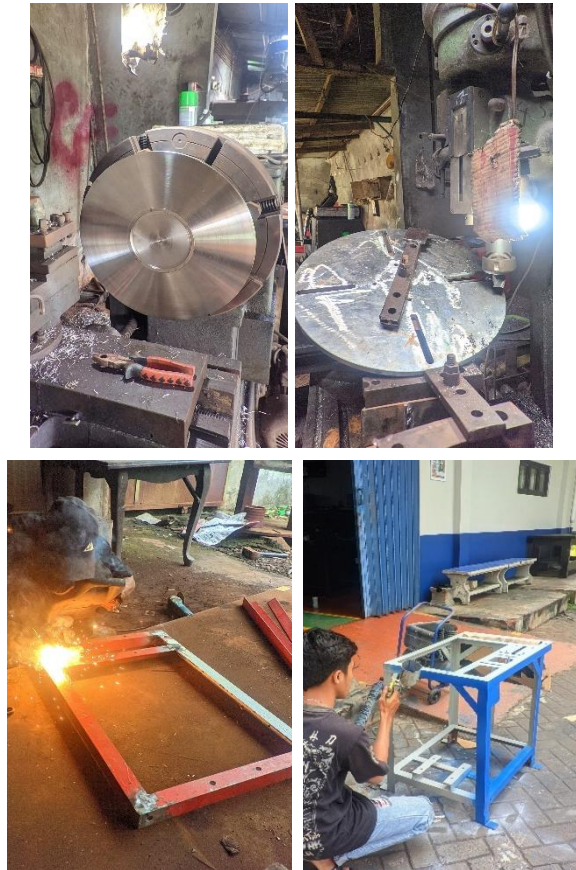
Gambar 4. Proses Manufaktur mesin perajang pisang kapasitas 59kg/jam
