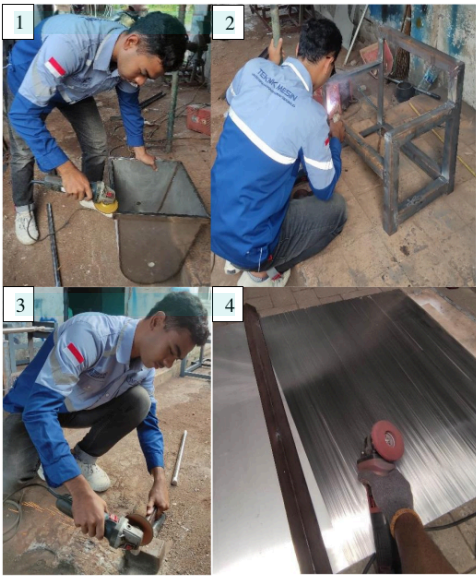
Gambar 2. Proses Manufaktur Mesin Pengaduk Adonan Kerupuk Ikan
