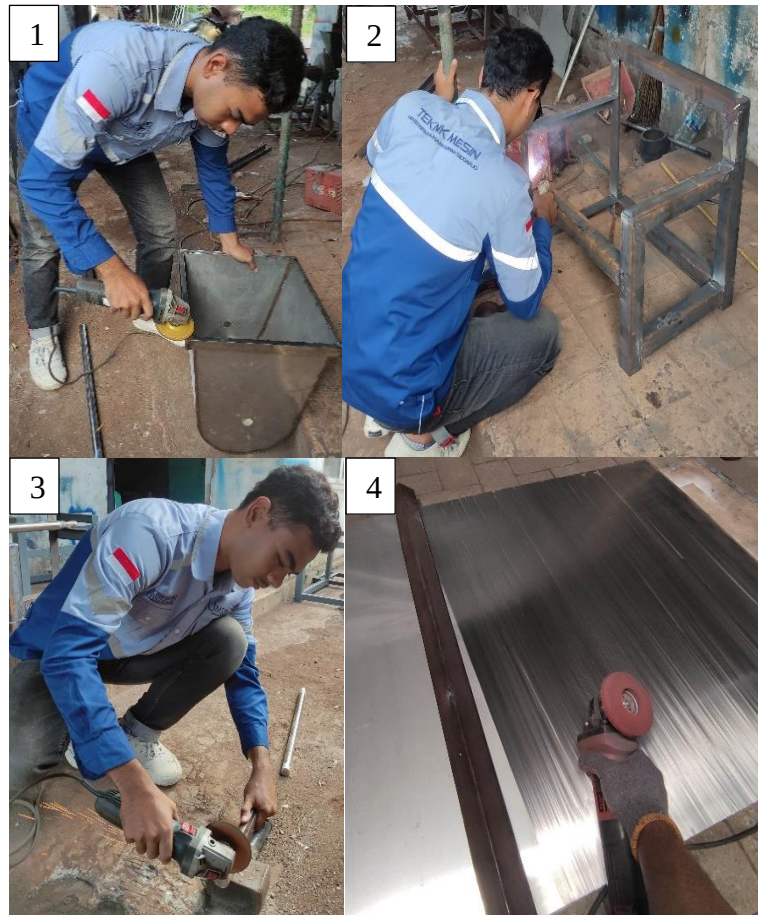
Gambar 3. Proses Manufaktur Mesin Pengaduk Adonan Kerupuk Ikan
