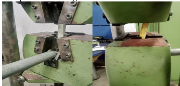
Gambar 6. Sampel Sandwich Panel sebelum dilakukan Uji Tekan dan sesudah dilakukan Uji
