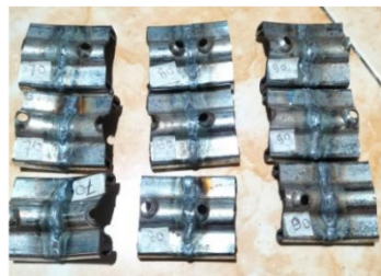
Gambar 10. Hasil Pengelasan TIG ( Tungsten Inert Gas ) Pada Velg Aluminium
