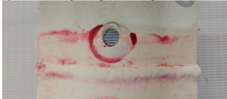
Gambar 12. Hasil Pengujian Liquid Penetrant Hasil Las Tungsten Inert Gas (TIG) pada Velg Aluminium
