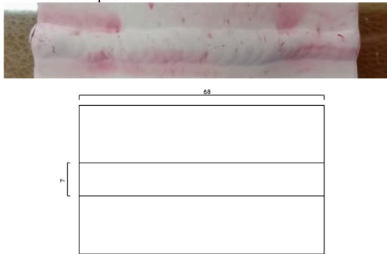
Gambar 20. Hasil Pengujian Liquid Penetrant Spesimen 2 Kuat Arus 120 Ampere Pada Gambar 20. Hasil Pengujian Liquid Penetrant Spesimen 1 Ampere 100 tidak ditemukan indikasi pada cacat pengelasan.
