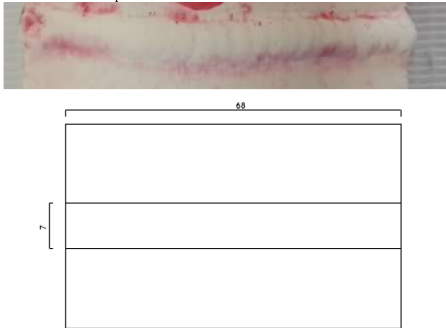
Gambar 15. Hasil Pengujian Liquid Penetrant Spesimen 3 Kuat Arus 100 Ampere Pada Gambar 15. Hasil Pengujian Liquid Penetrant Spesimen 1 Ampere 100 tidak ditemukan indikasi pada cacat pengelasan.
