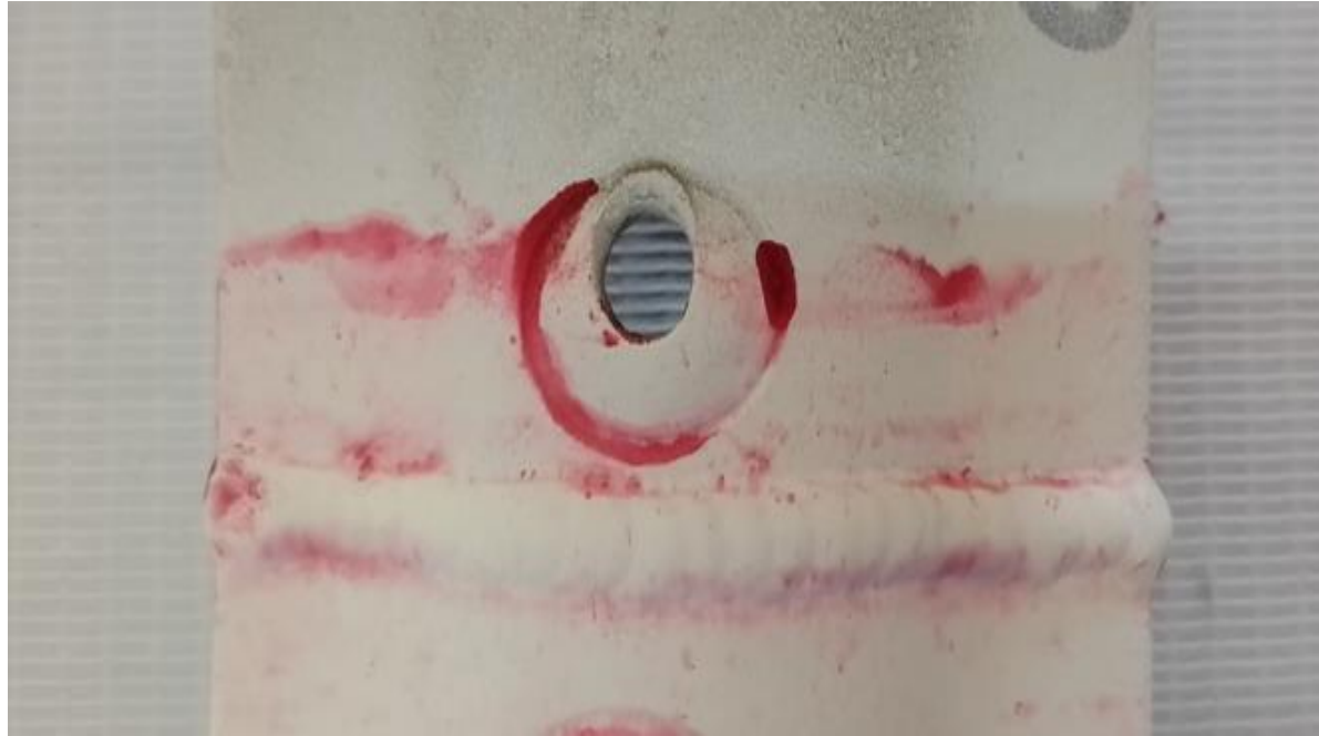
Hasil Pengujian Liquid Penetrant Hasil Las Tungsten Inert Gas (TIG) pada Velg Aluminium
