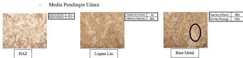
Gambar 15. Hasil Uji Mikrostruktur Media Pendingin Udara Setelah Pengelasan
