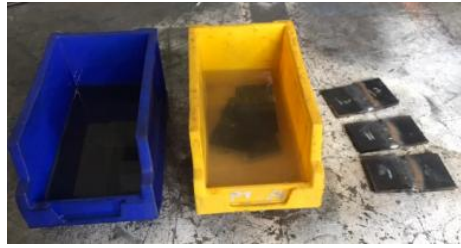
Gambar 6. Proses Quenching Spesimen
