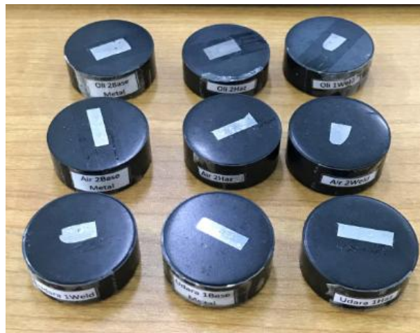
Gambar 12. Proses Pengecekan Mikrostruktur Setelah Pengelasan
