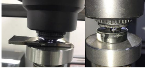
Gambar 7. Proses Uji Kekerasan Spesimen Setelah Pengelasan
