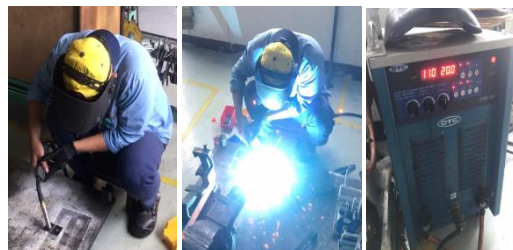
Gambar 4. Proses Pengelasan Bahan Uji dan Parameter Pengelasan
