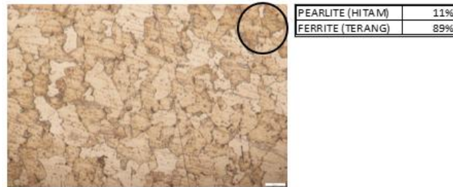
Gambar 3. 15 Mikrostruktur Area logam las quenching oli
