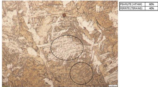
Gambar 3. 14 Mikrostruktur area HAZ quenching oli
