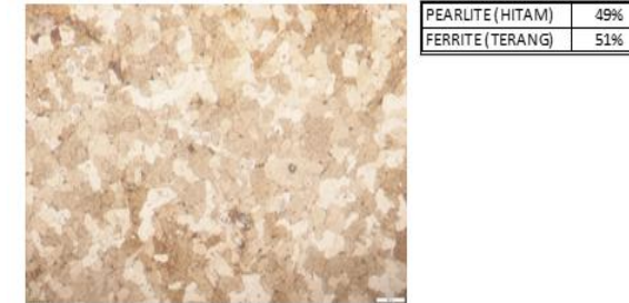
Gambar 3. 20 Mikrostruktur Area HAZ quenching udara
