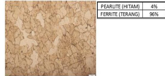
Gambar 3. 21 Mikrostruktur logam las quenching udara
