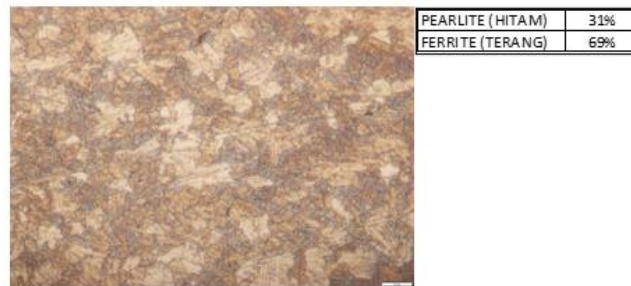
Gambar 3. 19 Mikrostruktur Area Base metal quenching air
