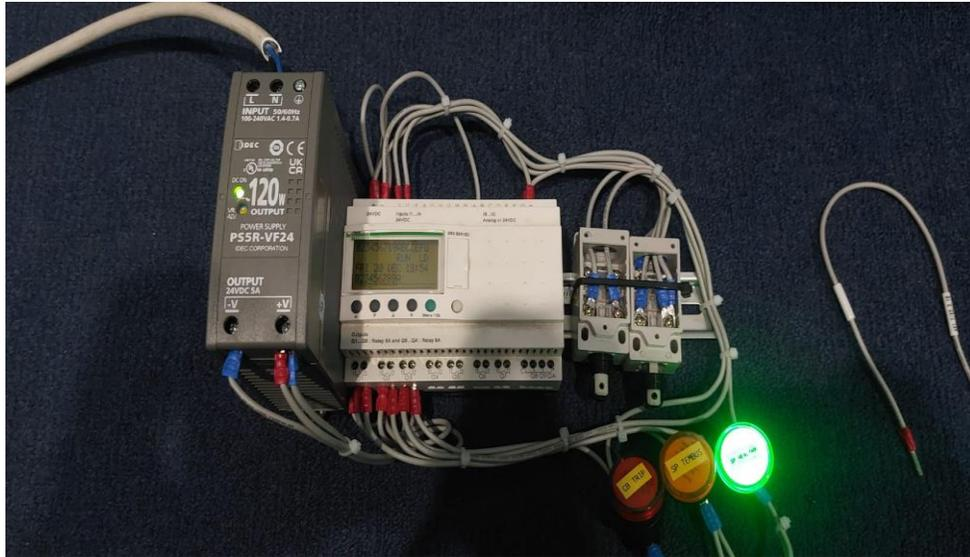
Kondisi Normal Terminal Relay Sudden Pressure Tidak mengalami Short Circuit (LED hijau)
