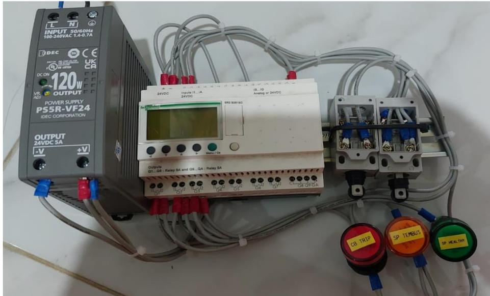
Melalui terminal I1 dan I2 Program akan bekerja secara otomatis tanpa berhenti selagi perangkat smart relay masih menyala.
