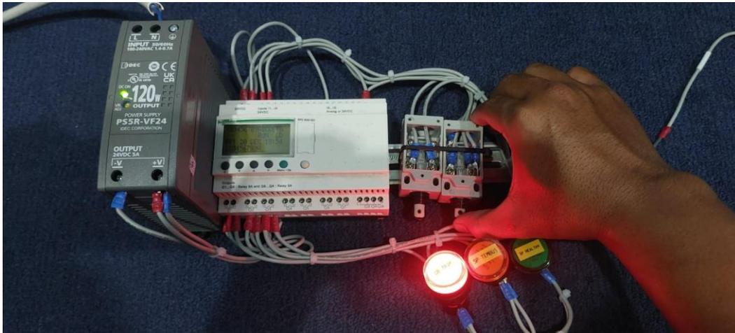
Kondisi terjadi hilang Tegangan positif atau Terjadi gangguan pada internal trafo pada (LED Merah)
