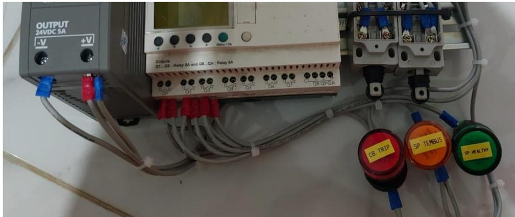
Gambar tampak bawah posisi sebuah Output terdiri dari supply 24Vdc , Terminal Q1,Q2,Q3 dan Lampu LED
