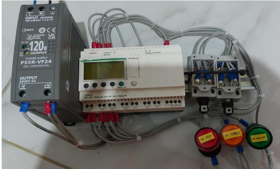
Pada gambar disamping sebelum adanya alat perancangan penggunaan smart relay sebagai alarm sudden pressure pada transformator 150kV apabila terjadi short circuit pada terminal relay sudden pressure maka relay akan memberikan sinyal langsung ke coil Circuit Breaker untuk menekan tombol off agar memadamkan transformator tersebut. Maka sebelum memberikan sinyal ke Circuit breaker Smart relay ini akan membackup terlebih dahulu dan memindahkannya ke rangkaian alarm
