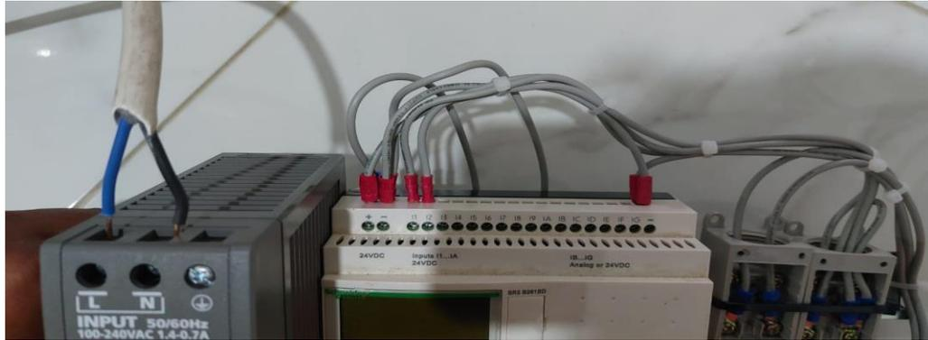
Gambar tampak atas posisi sebuah inputan terdiri dari supply 220Vac , Terminal + dan - Terminal I1 dan I2
