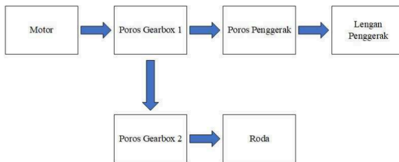
Gambar 10. Skema Gerakan Alat Tanam Padi
