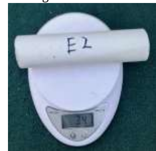
E2 Ditimbang Sesudah Dikubur di Tanah
