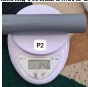
P2 Ditimbang Sebelum Dikubur di Tanah
