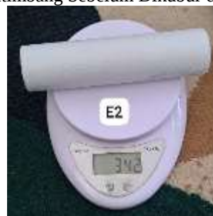
E2 Ditimbang Sebelum Dikubur di Tanah
