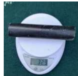
V2 Ditimbang Sesudah Dikubur di Tanah
