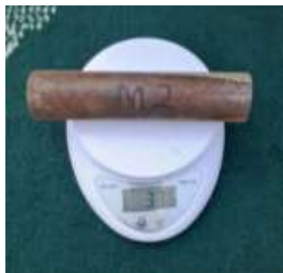
M2 Ditimbang Sesudah Dikubur di Tanah
