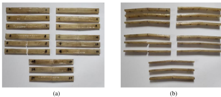
Gmabar 16. (a) Hasil Pengujian Bending (b) Hasil Pengujian bending Dari Samping
