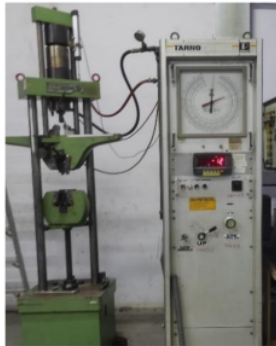
Gambar 6. Alat Uji Tarik Dan Uji Bending
