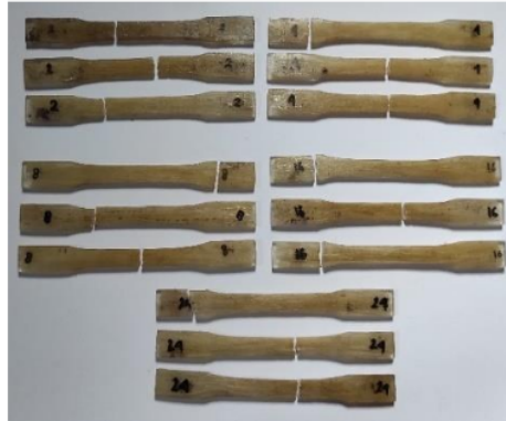
Gambar 10. Spesimen Hasil Uji Tarik
