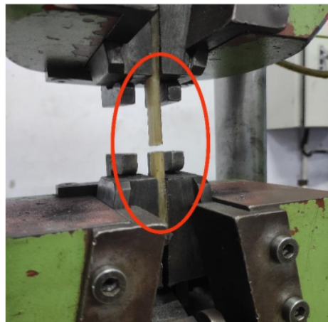
Gambar 9. Proses pengujian tarik
