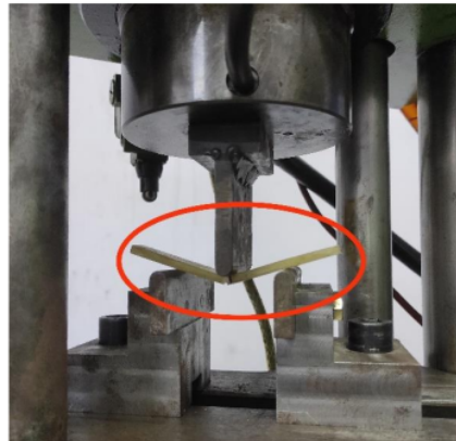
Gambar 15. Proses Pengujian Bending
