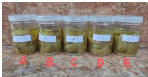
Gambar 7. Perlakuan Alkali (A) 2 Jam, (B) 4 Jam, (C) 8 Jam, (D) 16 Jam dan (E) 24 Jam
