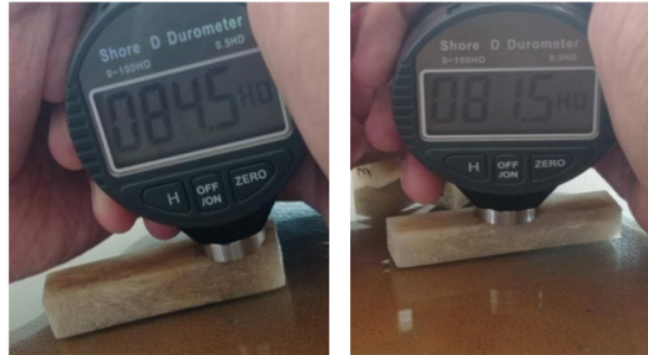
Gambar 19. Proses Pengujian Spesimen Pada Uji Kekerasan Shore D
