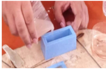
Gambar 13. Proses Penuangan Resin Yang Sudah Dicampurkan Serat Beserta Amilum Kedalam Cetakan Silicon
