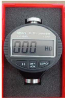
Gambar 10. Alat Uji Kekerasan Shore Durometer Digital
