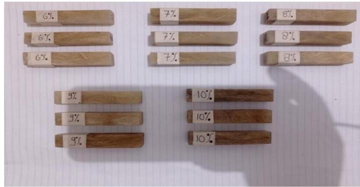
**Gambar 18.** Spesimen Uji Kekerasan Shore D
