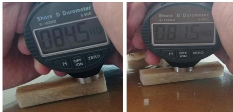
**Gambar 19.** Proses Pengujian Spesimen Pada Uji Kekerasan Shore D
