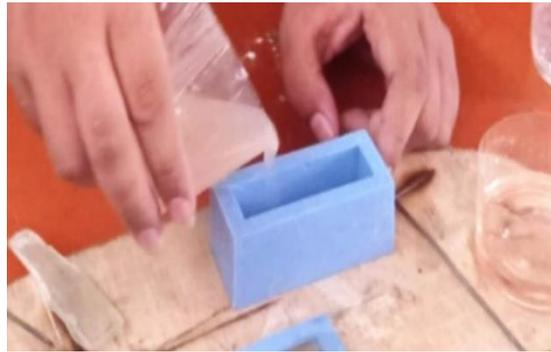
**Gambar 13.** Proses Penuangan Resin Yang Sudah Dicampurkan Serat Beserta *Amilum* Kedalam Cetakan *Silicon*
