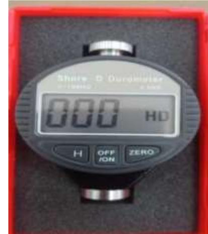
Pengujian kekerasan shore D ini bertujuan untuk mengetahui nilai ketahanan benda uji terhadap penetrasi suatu bahan yang lebih keras dengan bentuk dan pengaruh gaya tertentu sehingga akan diperoleh nilai kekerasan benda uji
