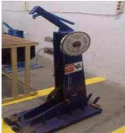
Pengujian *impact* ini menggunakan alat uji berjenis *Promes Charpy Impact Test* dengan kapasitas maksimal energi yang diserap oleh alat uji ini sebesar 200 *Joule* milik laboratorium teknik mesin politeknik negeri malang. Alat uji *impact* ini digunakan untuk mengukur ketangguhan suatu material, yaitu kemampuan material untuk menyerap energi sebelum mengalami kerusakan atau patah.
