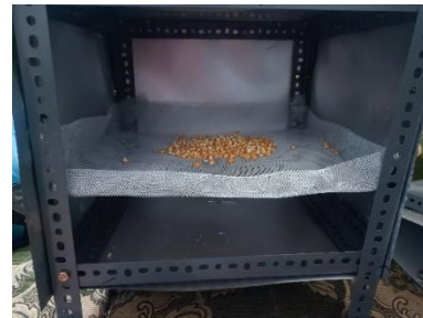
Gambar 2. Rangka Pengering Benih Jagung Menggunakan Elemen Pemanas dengan Cam ESP-32.
