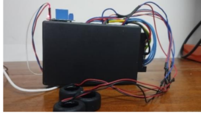
Gambar 5. Alat pemantauan dan peringatan berbasis Telegram.
