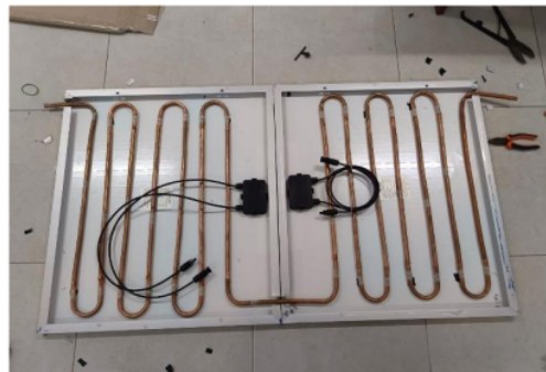
Gambar 3. Desain pipa tembaga pada Panel Surya
