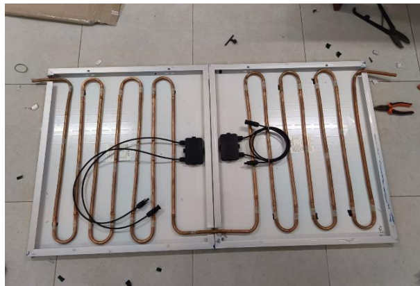
Gambar 3. Desain pipa tembaga pada Panel Surya
