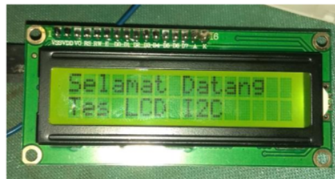
Gambar 4.10 Hasil pengujian liquid crystal display
