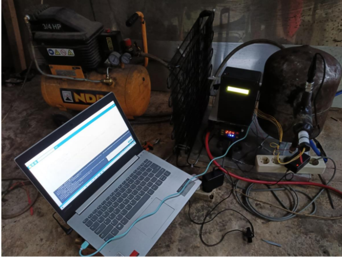
Gambar 5. Penempatan perangkat monitoring air dryer kompresor
