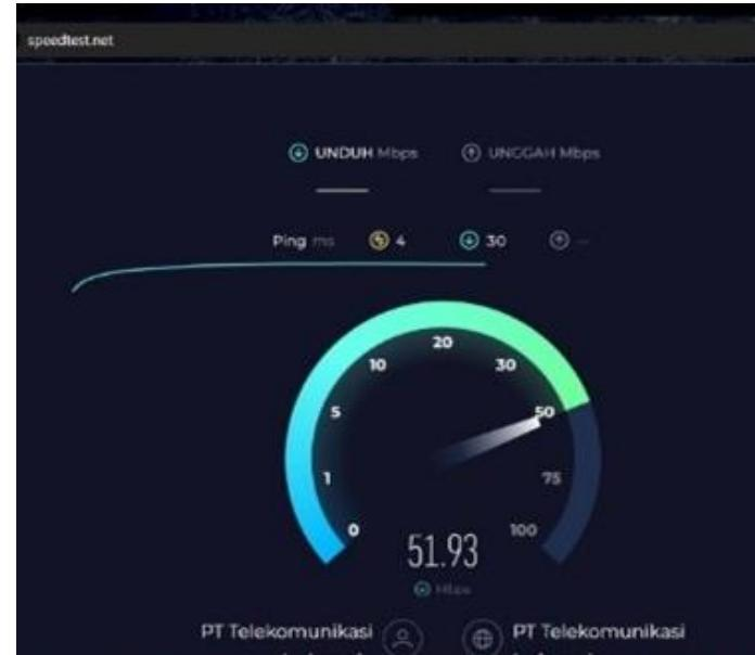
Gambar diatas adalah hasil pengujian speedtest dititik A (sumber internet utama) Untuk bandwidth dari ISP adalah sebesar 50 Mbps, dan hasil pengujian sebesar 51 Mbps.
