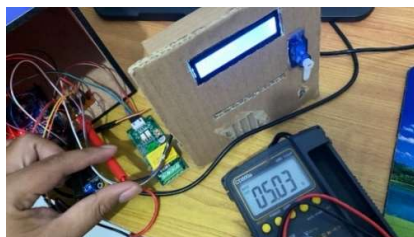
Gambar 6 Pengujian Modul PZEM-004T untuk Pengukuran Tegangan dan Arus
