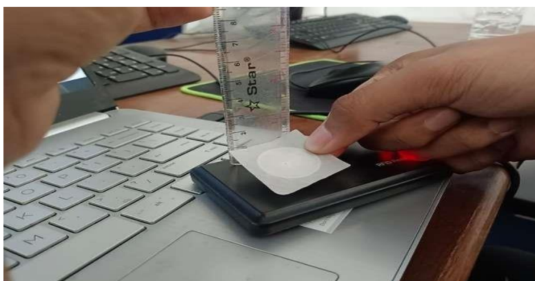
Gambar 5. Foto Pengujian Jarak Baca RFID
