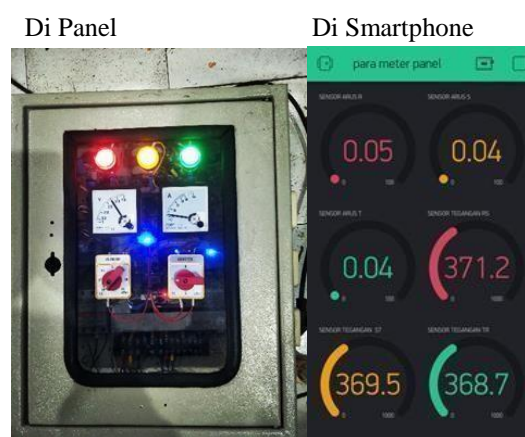
Gambar 3.8 Pengujian Keseluruhan Alat menggunakan smartphone Oppo F3 pada Jarak 88km dengan Tegangan T+R dan Arus Fasa T
