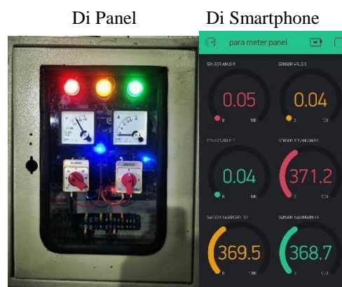
Gambar 3.6 Pengujian Keseluruhan Alat menggunakan smartphone Oppo F3 pada Jarak 88 km dengan Tegangan Fasa R+S dan Arus Fasa R
