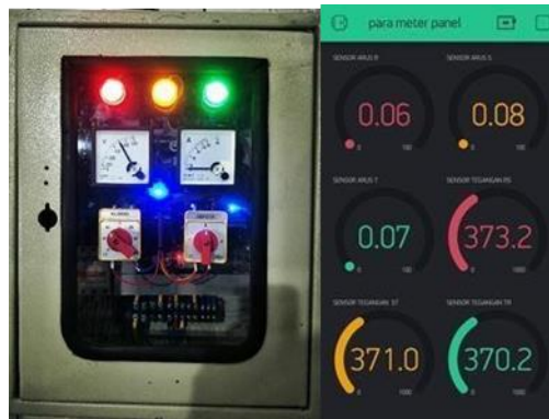
Gambar 3.9 Pengujian Keseluruhan Alat menggunakan smartphone Oppo Reno 7 5G pada Jarak 88 km dengan Tegangan Fasa R+S dan Arus Fasa R
