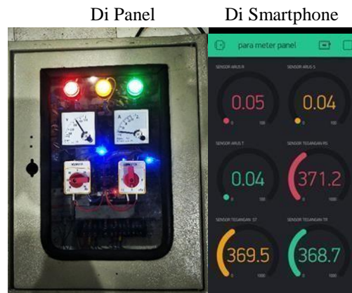
Gambar 3.7 Pengujian Keseluruhan Alat menggunakan smartphone Oppo F3 pada Jarak 88 km dengan Tegangan S+T dan Arus Fasa S
