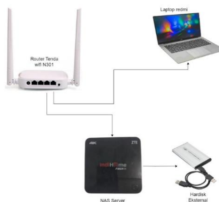
Gambar 3 Instalasi Jaringan Nas
