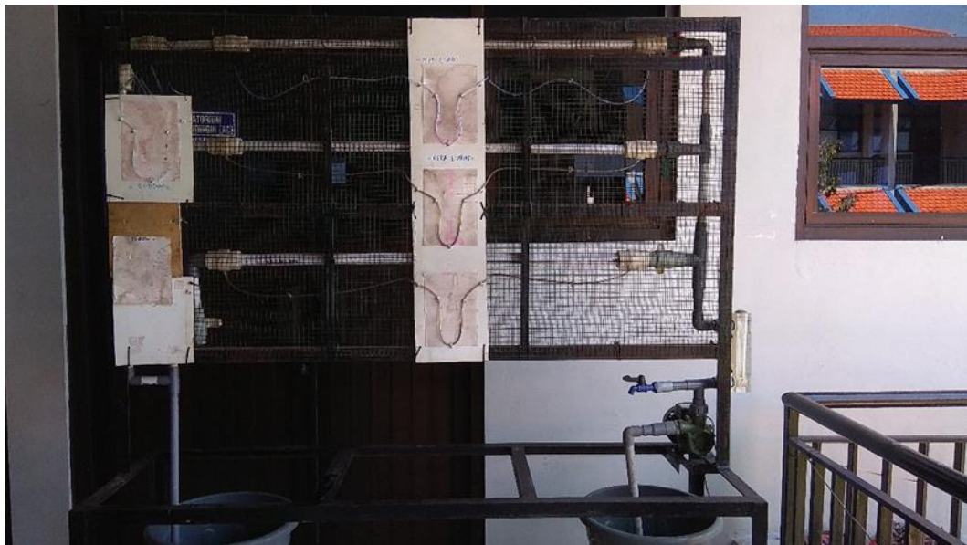
Gambar 1. Manometer Sederhana semua penulis berasal dari satu afiliasi, tanda ini tidak perlu diberikan.
