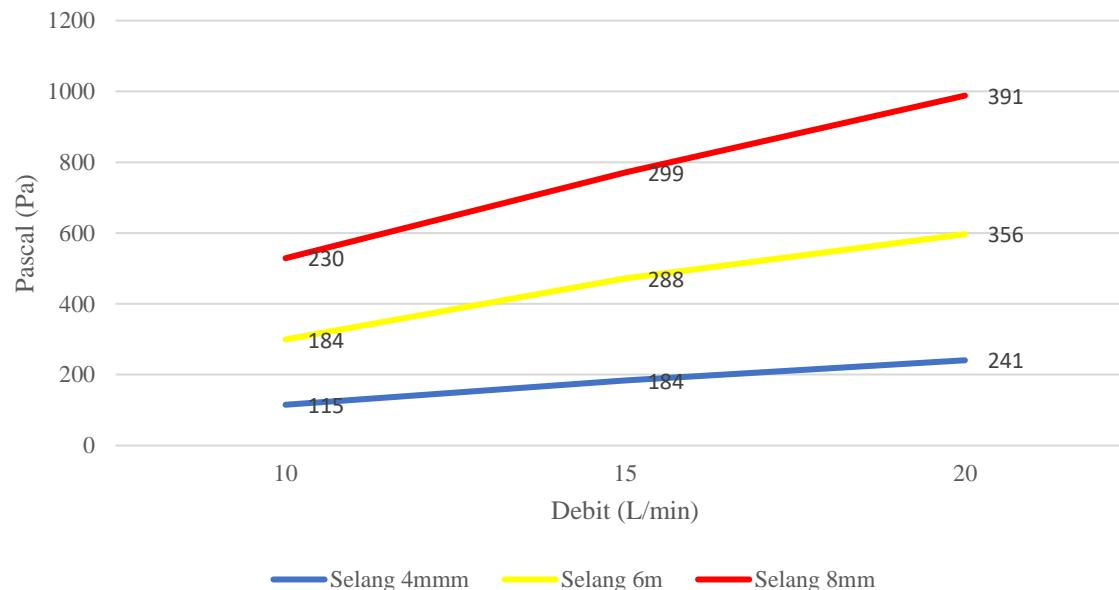
Perbandingan Tekanan Selang Manometer Terhadap Debit Aliran Pada Elbow
