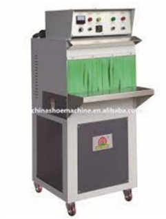
Gambar 4. Mesin steam (pemanas)
