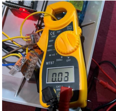
Gambar 3.2. Pengujian Tegangan Menggunakan AVO Meter
