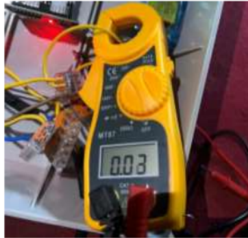
Gambar 7. Pengujian Tegangan Menggunakan AVO Meter
