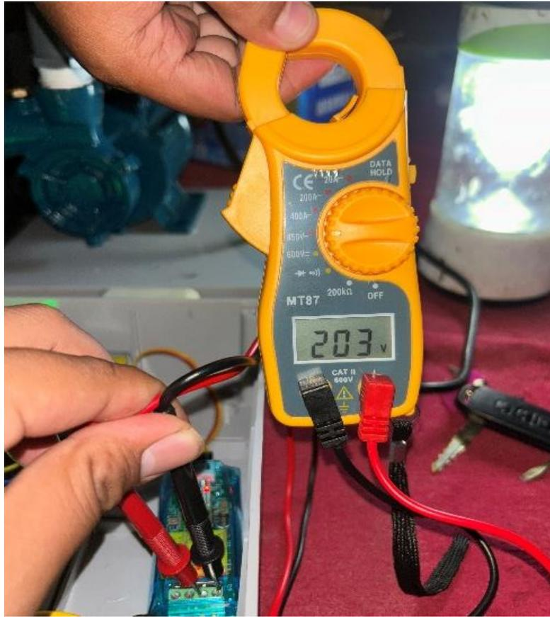
Pengujian ini dilakukan untuk mengevaluasi keakuratan pembacaan tegangan pada sensor PZEM-004T. Pengujian dilakukan dengan membandingkan nilai yang muncul pada google spreadsheet dengan alat ukur standart (AVO Meter). Arahkan selector dari AVO Meter pada 450VAC
