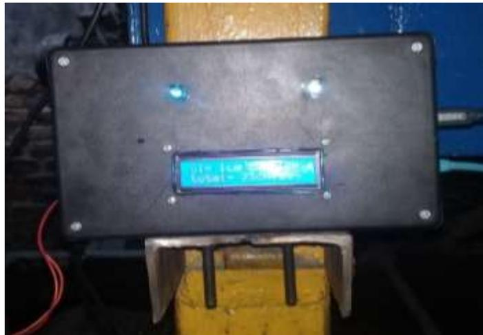
Pada gambar tersebut besi beton eser sebagai jalur untuk mengatur jarak antara sensor dengan tiap sisi tread. Terdapat baut ukuran  $\frac{1}{4} \times 2''$  untuk tempat dudukan sensor yang dapat di atur untuk tinggi rendahnya sensor. Pada saat pengujian sensor tedapat pembacaan yang tidak sesuai dengan jarak yang seharusnya akhirnya diperlukan kalibrasi untuk sensor. Tempat sensor tersebut dipasang pada tengah roller tempat jalur tread. Pembacaan sensor tersebut ditampilkan pada LCD I2C 16x2.
