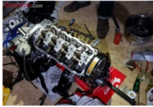
Gambar 10. Pembongkaran Dan Pemeriksaan Mesin
