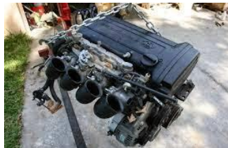
Gambar 14. Pemasangan Kembali Mesin Setelah Overhaul
